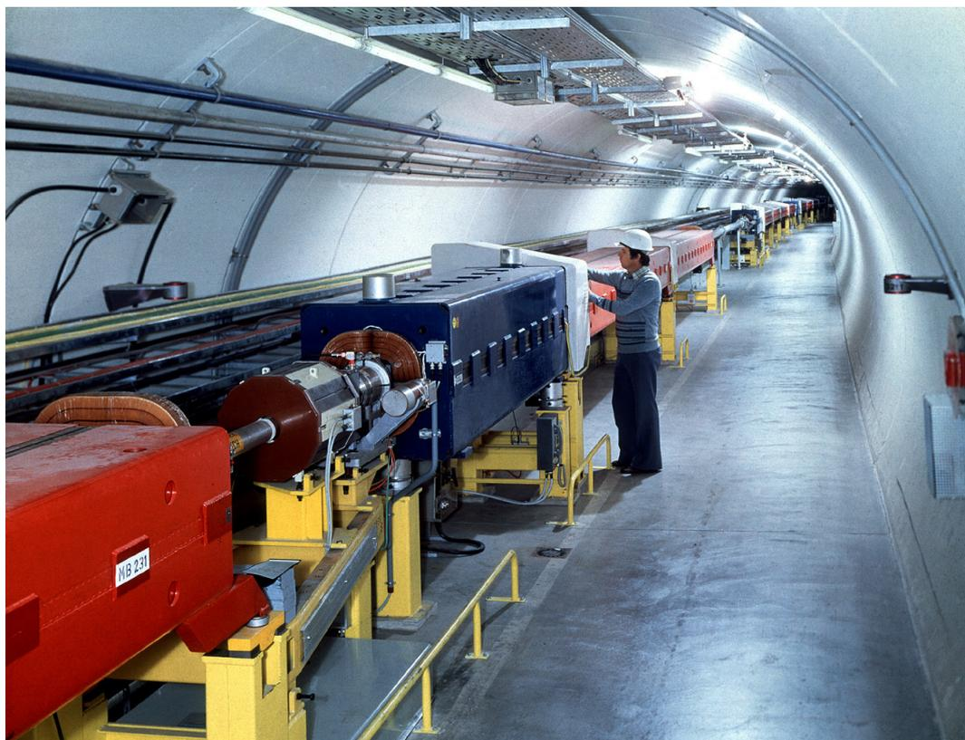
Figura 3.14: Tunnel dell'SPS del CERN (3.8 Km di circonferenza): accelera protoni fino a 450 GeV
