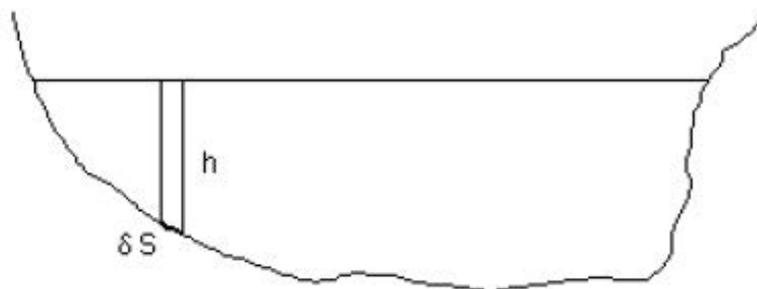
Figura 1.9: *analisi componente forza di pressione verticale*
