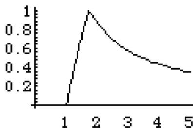
Figura 5.10: Intensità del campo prodotto dalla corrente  $I$  in un filo di raggio  $R$  con un buco di raggio  $r$ .
